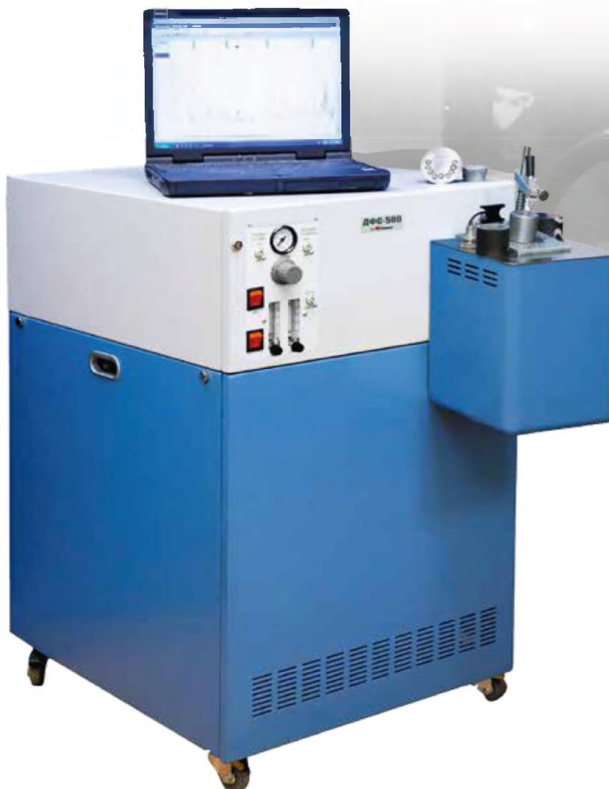
**Предназначен для анализа черных и цветных металлов на все легирующие элементы и примеси, включая серу, фосфор, углерод.**
