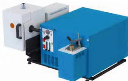
В универсальном оптико-эмиссионном спектрометре ДФС-500 подобраны и совмещены такие технические решения, которые позволяют проводить анализ металлов с точностью, в несколько раз превышающей требования ГОСТ и ТУ.
