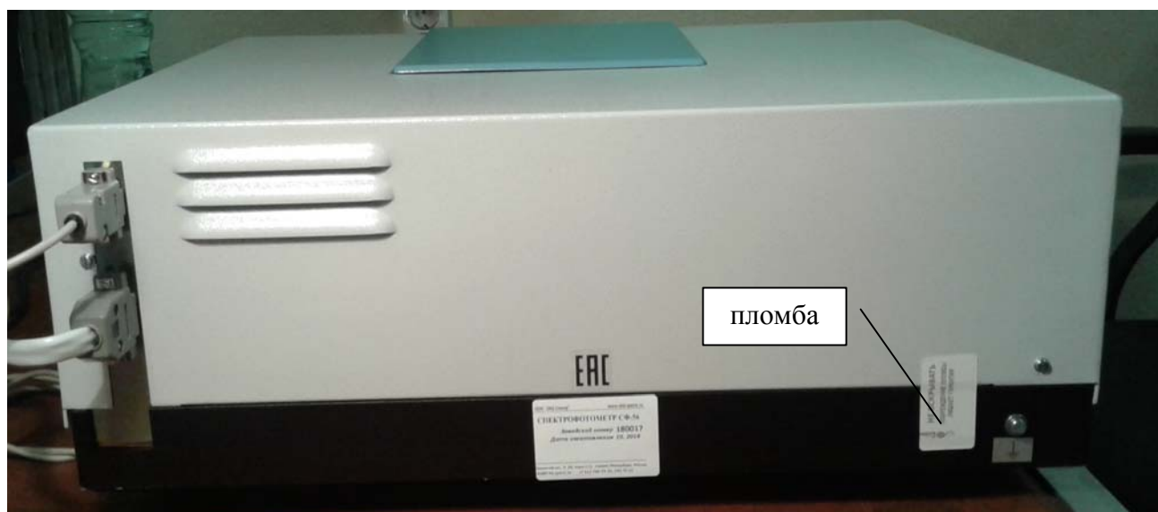
Рисунок 2 – Схема пломбировки спектрофотометра
